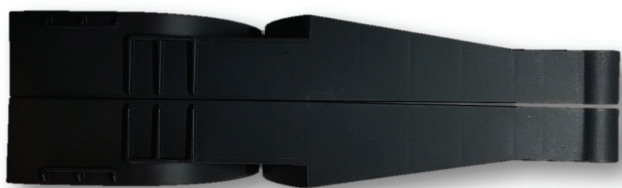
Rys. 1. Zdjęcia wypraski przed optymalizacją kształtu - widoczna deformacja przystających do siebie dwóch wyprasek
