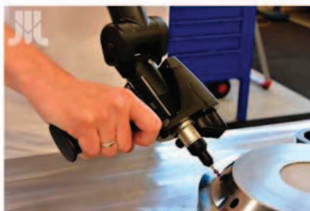
Rys. 3. Współrzędnościowa maszyna pomiarowa a), ramię pomiarowe b) Fig. 3. A coordinate measuring machine a), measuring arm b)
