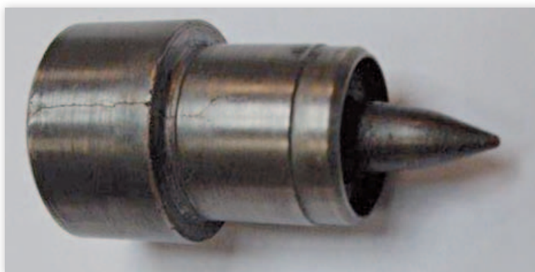
Rys. 3 Dysza GK uszkodzona
